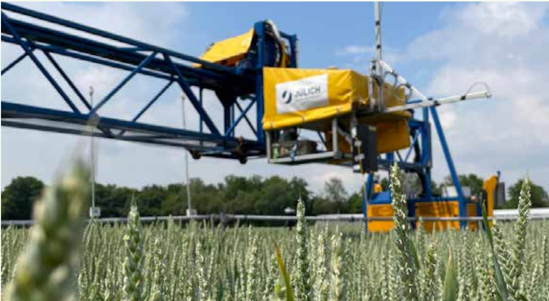
Sensor-Plattform zur Quantifizierung von strukturellen und photosynthetischen Pflanzenmerkmalen
